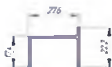
Алюминиевый профиль окантовочный, вес 0,273 кг/п.м. (под 25 панель)
