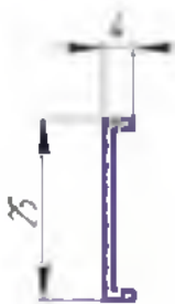
Алюминиевый профиль НЧП 5300 (направляющая клапана для решеток АНР, АДР), вес 0,114 кг/п.м.
