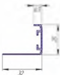
Алюминиевый профиль H47 3072 (рамка решёток АНР, АНР), вес 0,188 кг/пм
