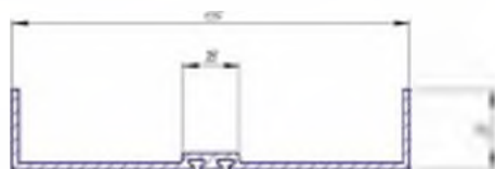
Алюминиевый профиль PS 110, вес 0,991 кг/п.м (верх-низ для клапана АВК)
